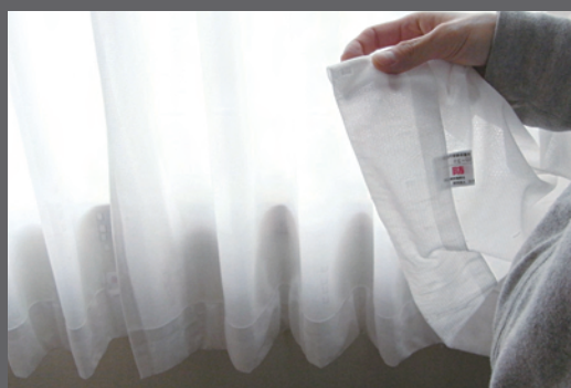
持ち込みによる居室の防災製カーテン
