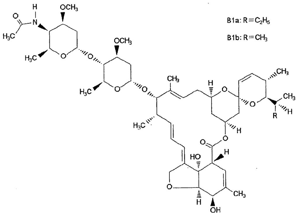
分子式 : ①エプリノメクチン B1a C<sub>50</sub>H<sub>75</sub>NO<sub>14</sub>
