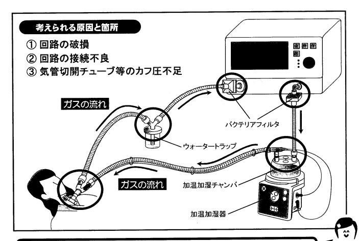
「不確実な接続」,「誤接続」,「蛇管の亀裂やチャンバの破損」などに 十分注意してください。特に、ウォータートラップは見落としがちです!
