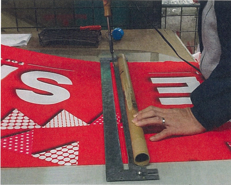
化繊の旗などにホットナイフを当てて熱でカットしていく作業
