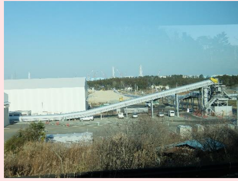
土砂を運ぶベルトコンベアが縦横無尽に施設内に配置されていました。
