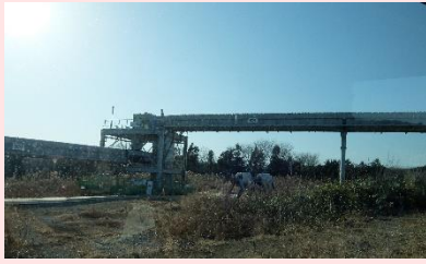
土砂を運ぶベルトコンベアが縦横無尽に施設内に配置されていました。
