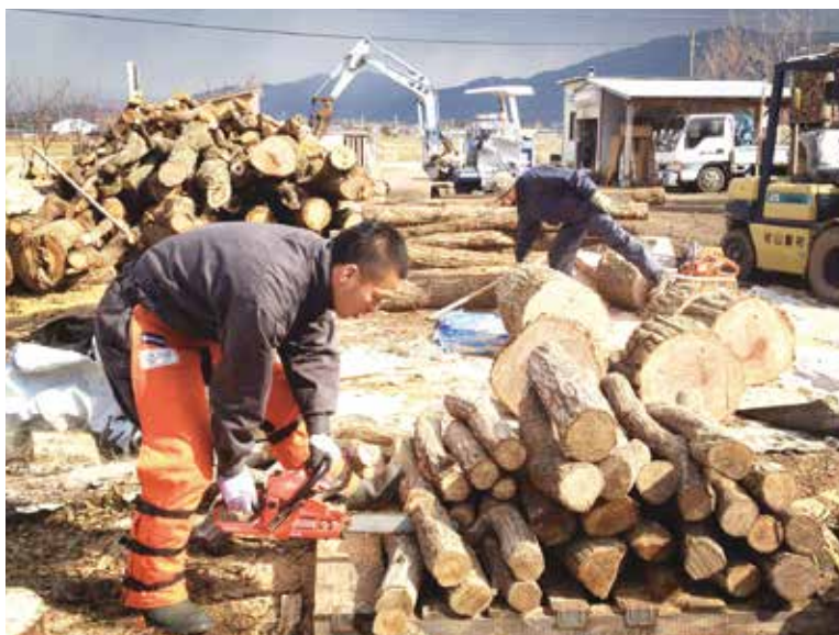
丸太をチェーンソーで玉切りする
