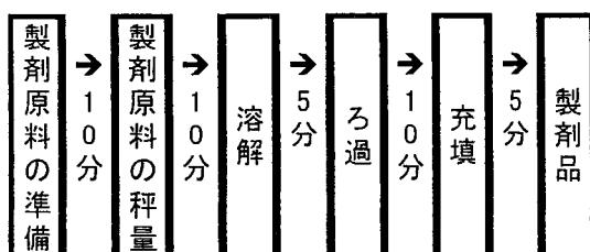
点眼剤は無菌操作で調製しているケースが多かった。タイムスタディ調査を行った製剤も無菌操作で行われていた。設備としてはクリーンベンチ、器具ではシリンジ、分注器などであり、予め滅菌したものを使用していた。原料医薬品を溶解後メンブランフィルターでろ過し、容器に分注して製した。製剤量は比較的小量ずつで、こまめに調製されていた。要した時間は溶解、ろ過、分注それぞれ5分、10分、10分であった。
